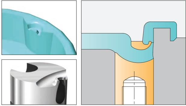
**rounded separation** / separación bombeada / séparation bombée
